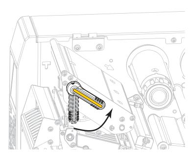
3. 如图所示,旋转介质导板调节旋钮,直到介质导板完全滑出。
