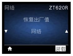
可将特定打印机、打印服务器和网络设置恢复为出厂默认值。在恢复出厂值时应小心,因为执行此操作后,将需要重新加载您已经手动更改的所有设置。这个菜单项可通过两个带有不同默认值的用户菜单访问。
