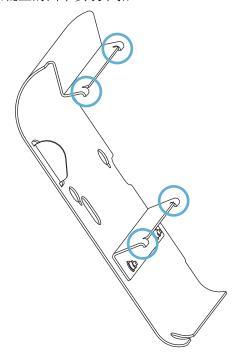
**3.** 将回卷辊上的安装卡扣插入打印机的安装槽,然后将回卷辊滑向左侧,直至无法移动为止。
