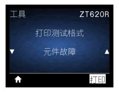
打印机打印一张横向图像,该图像专用于显示打印头元件能否正常工作。
