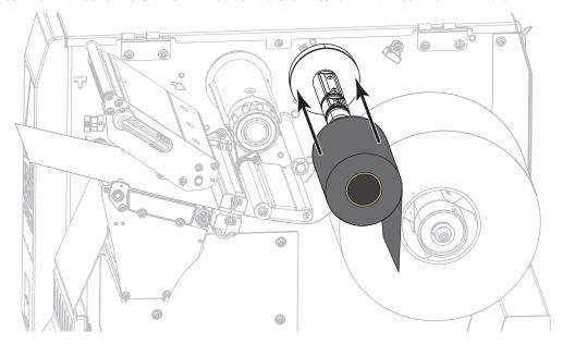
4. 如图所示,将色带穿过打印头总成下方并缠绕在左侧。
