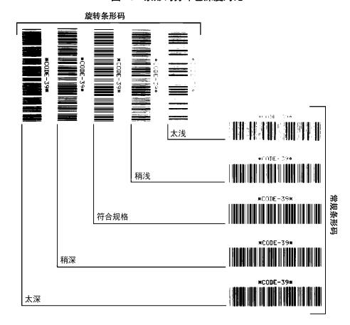
图 18 • 条形码打印色深度对比
