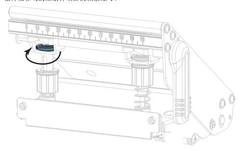
3. 根据需要,调节压紧件的位置,以便在介质上施加均匀的压力。对于非常窄的介 质,应将内侧压紧件放置在介质的中央,并减小外侧压紧件上的压力。
