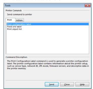
**4.** 单击 Send (发送) 打印一张打印机配置标签。 如果连接工作正常,且打印机正确装入介质和色带 (如果已使用),打印机配置标签将会被打印出来。
