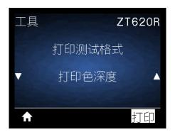
打印机以不断增加的打印色深度等级重复打印同一张图像。当图案清晰可辨时,随时按 CANCEL (取消)按钮停止打印过程。
