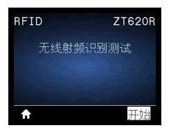
在无线射频识别 (RFID) 测试中,打印机尝试读取并写入应答器。测试过程中打印机不会运转。
