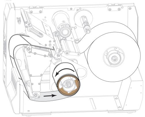
10. 如图所示,旋转介质导板调节旋钮,直到介质导板刚好接触到介质边缘。
