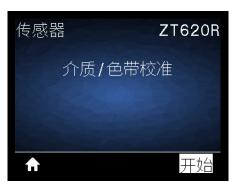
校准打印机,调节介质和色带传感器的灵敏度。
