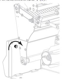
**2.** 使回卷 / 背衬拾取辊上的锁眼的大孔对准压花螺母,然后将回卷 / 背衬拾取辊滑下去,直到碰到螺栓。
