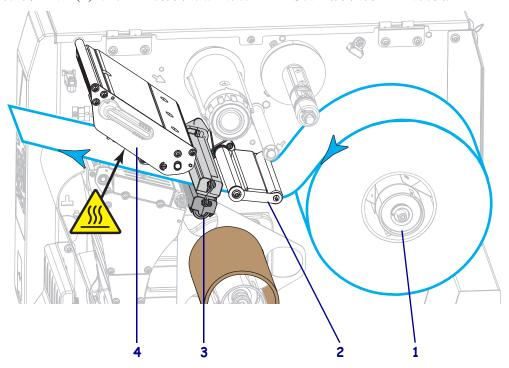
7. 从打印机中将介质拉出大约500毫米(18英寸)。
