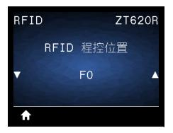
如果通过 RFID 标签校准没有达到所要求的程控位置 (读取/写入位置),则可能要指 定一个值。
