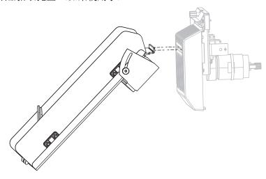
5. 松开并卸下切纸器外壳上的指拧螺钉和锁紧垫片。
