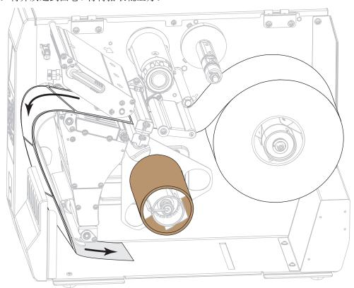
9. 将介质缠绕在回卷轴上 (如图所示)。将回卷轴旋转几圈,拉紧介质,以收紧松弛 部分。
