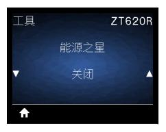
启用"能源之星"模式后,打印机在超时阶段后即进入"睡眠"模式,从而降低能耗。按控制面板上的任意按钮都可以让打印机回到启动状态。
