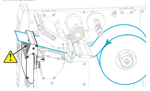
6. 如图所示,旋转介质导板调节旋钮,直到介质导板刚好接触到介质边缘。
