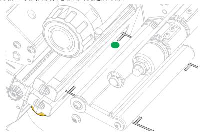
**3.** 如有必要,转动金色的透射式介质传感器调节轮,使传感器移动到介质上的凹口或 孔眼位置。
