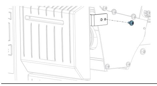
**8-b.** 向右滑动切纸器模块,使切纸器总成的卡扣 (1) 和切纸器盖的卡扣 (2) 对齐打印机上相应的槽 (3),然后抬起切纸器模块,使其脱离打印机。小心不要弄坏连接切纸器模块和打印机的线。根据需要,可以断开这些线。
