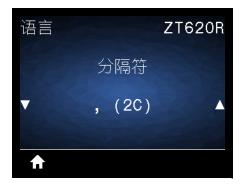
分隔符是一个两位十六进制值,在 ZPL/ZPL II 格式指令中用作参数位置标记符。设置 分隔符, 使其与标签格式中使用的值匹配。
