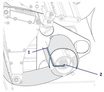
12. 如图所示,旋转介质导板调节旋钮,直到介质导板刚好接触到介质边缘。
