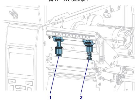
图 17•打印头压紧件
