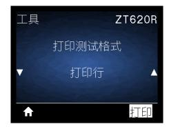
打印机多次以不同的速度启动一个测试序列,打印一张油墨 / 打印头测试图像。当对打印机的机械组件进行调节时,可以使用这些测试标签,也可用于确定打印头元件工作是否正常。
