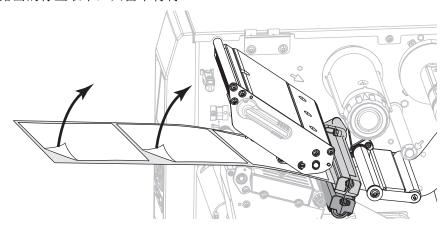
5. 将介质拉入打印机,以便只让背衬位于介质传感器底部的绿灯上方。
