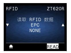
从位于 RFID 天线上方的 RFID 标签中读取并返回指定的标签数据。读取标签数据的过 程中打印机不会运转。打印头会打开或关闭。
