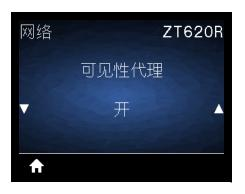
当打印机连接到有线或无线网络后,其将使用已加密、有证书认证的网络套接字连接尝试通过基于云的 Zebra Printer Connector 连接至 Zebra 的 Asset Visibility Service。打印机将发送发现数据、设置和警报数据。通过任何标签格式打印的数据将不会被传输。
