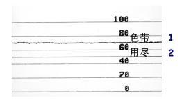
介质传感器校正图 (图 22) 传感器校正图上标为 "介质"(1) 的线条表示介质传感器 读数。介质传感器阈值设置是由 WEB (网纹) (2) 表示的。纸张用尽阈值是由 OUT (用尽)(3)表示的。向下的尖头(4)表示标签中间的间隙(网纹),尖头(5)之间的线 表示标签所在的位置。
