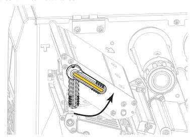
3. 将色带卷装载到色带供应轴上,并将色带松开端依图展开。将色带卷尽量向后推。
