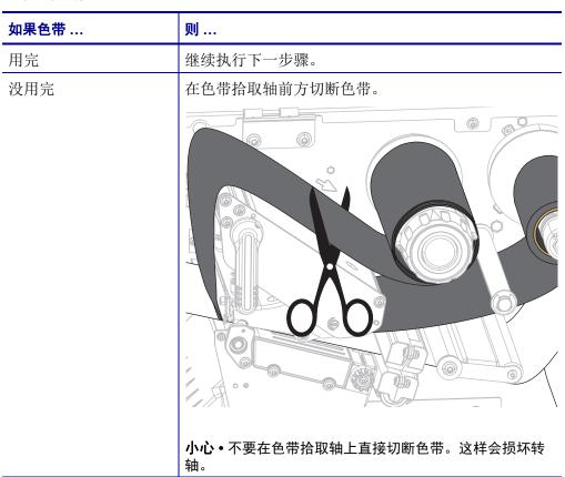
2. 握住色带拾取轴,同时将色带松开旋钮向左转动,直到停止。
