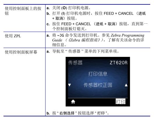
将结果与本章节中显示的实例对比。如果必须调节传感器的灵敏度,请校准打印机 (参见第 191 页的"校准色带和介质传感器")。
