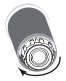
色带松开杆向下旋转, 放松轴杆对旧色带的拉紧程度。
