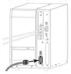
15. 将交流电源线的插头一端插入适合的电源插座。
