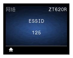
扩展服务集标识符 (ESSID) 是用于无线网络的标识符。该设置为当前的无线配置提供 ESSID,但无法通过控制面板进行修改。
