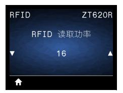
如果通过 RFID 标签校准没有达到所要求的读取功率,则可能要指定一个值。
