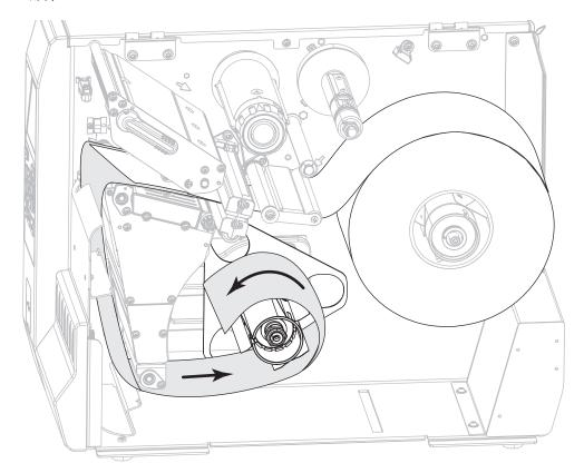
11. 重新将轴钩安装到背衬上。将轴钩长的一端插入导板 (1) 的小孔中。将轴钩短的一 端插入调节螺母(2)中心的孔中。
